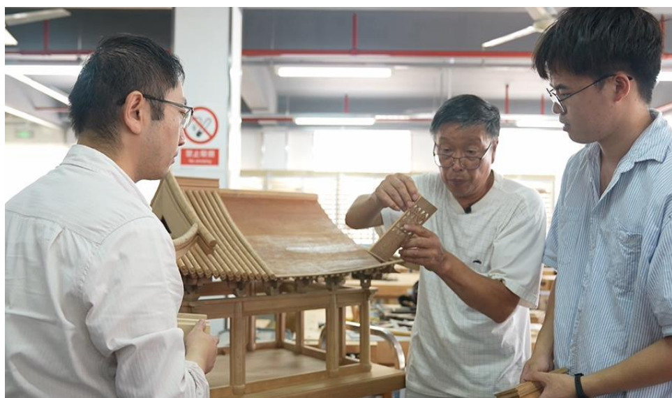
图 2-17 大师指导师生学徒进行仿宋式歇山顶大殿中的木门制作
